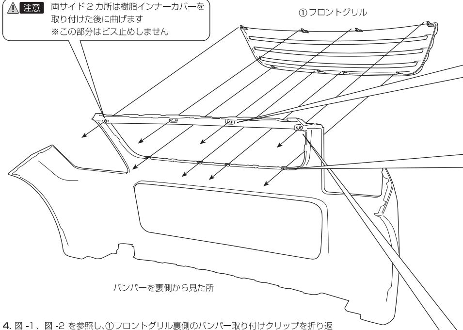
4. 図-1、図-2を参照し、①フロントグリル裏側のバンパー取り付けクリップを折り返すように曲げ、フロントグリルを固定します。
